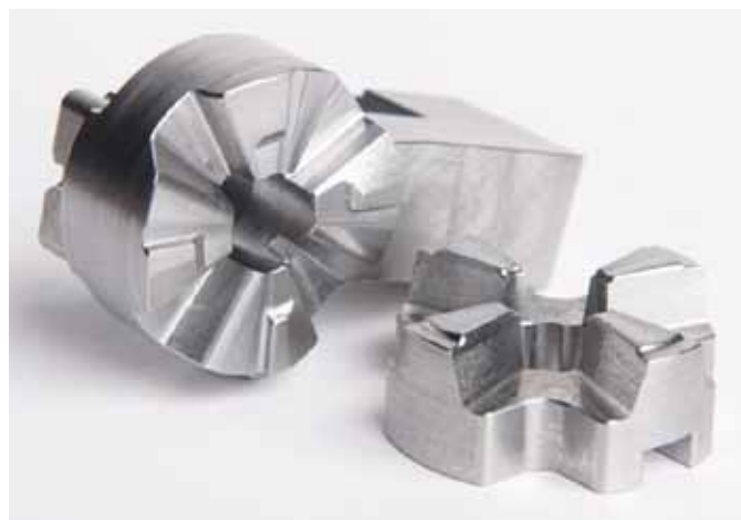
3D-Flächen: Die Nockenteile werden aus Vollmaterial gefräst und kommen bei Prototypen für die Höhenverstellung der Lenksäule zum Einsatz.
